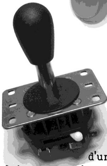
Ca, c'est le dessous d'un joystick, il faudra faire attention au moment de relier les connecteurs à la carte usb pour ne pas se retrouver avec les directions dans le mauvais sens !
